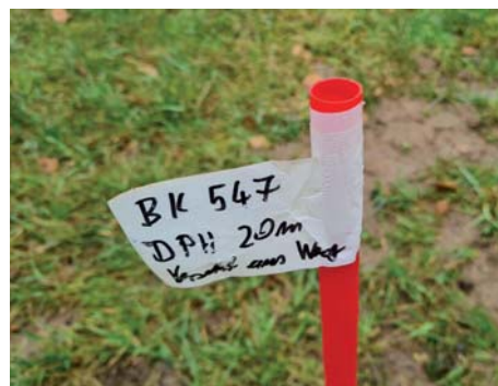
Rammsondierungspunkt für die Zuleitung vom Stall zur MIDAL zwischen Lautern und Gadernheim
