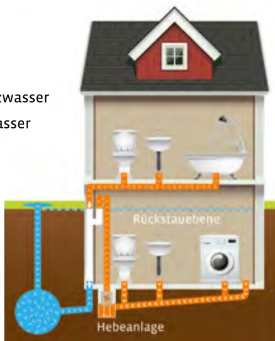
Dies ist die sicherste Art der Rückstausicherung. Das Wasser fließt vom Ausguss zunächst in einen abgedeckten Schacht – die Hebeanlage. Von dort wird es durch eine Pumpe über das Niveau der Rückstauenebene gehoben und ins Kanalnetz eingeleitet.
